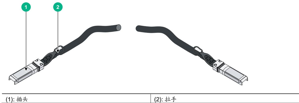
图3-2 SFP+光缆外观示意图
