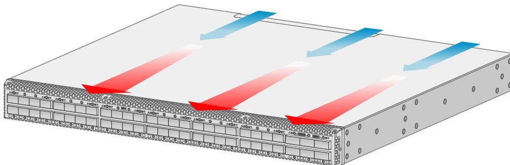
图4-2 端口侧进入电源侧排出散热空气流向示意图
